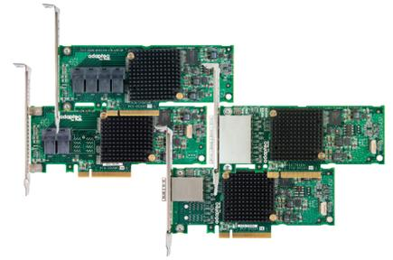
8端口和16端口PCIe Gen3 HBA提供高性能I/O和低延迟，以及广泛的设备兼容性、可扩展性和灵活性
