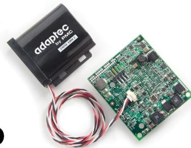
RAID コントローラカード上のオンボードキャッシュを有効にすると、特に RAID 5 や RAID 6 の場面では、データのリードキャッシュとライトキャッシュの両方を利用することで、パフォーマンスを顕著に向上させます。しかし、電源やシステム障害の際にキャッシュが保護されていないと、ライトキャッシュに保存されたデータは損失する可能性があります。
