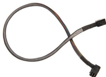
Adaptec ACK-I-rA-HDmSAS-HDmSAS-1M と 0.5M は内部ライトアングル mini SAS HD x4 (SFF-8643) to mini SAS HD (SFF-8643) ケーブルです。1 または 0.5 メートル長、8/8Q/7/7Q/7H/7He シリーズアダプタとmini SAS HDコネクタのSAS/SATA バックプレーンを接続するのに使用します。
