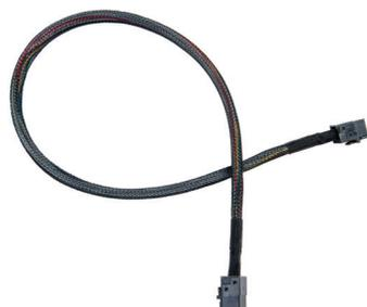
Adaptec ACK-I-HDmSAS-HDmSAS-1M と .5M は内部 mini SAS HD x4 (SFF-8643) to mini SAS HD x4 (SFF-8643) ケーブルです。1 または 0.5 メートル長、8/8Q/7/7Q/7H/7He シリーズアダプタとmini SAS HDコネクタのSAS/SATA バックプレーンを接続するのに使用します。
